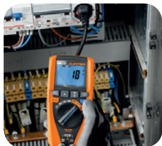
Impedanzmessung ohne RCD-Auslösung.
