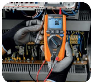
LoZ Funktion eliminiert Streuspannungen.
