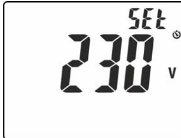
Abb. 6: Einstellung der Nennspannung bei Loop Messungen
