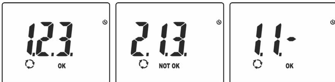
Abb. 16: Ergebnisse des Tests der Phasenfolge und der Phasengleichheit
