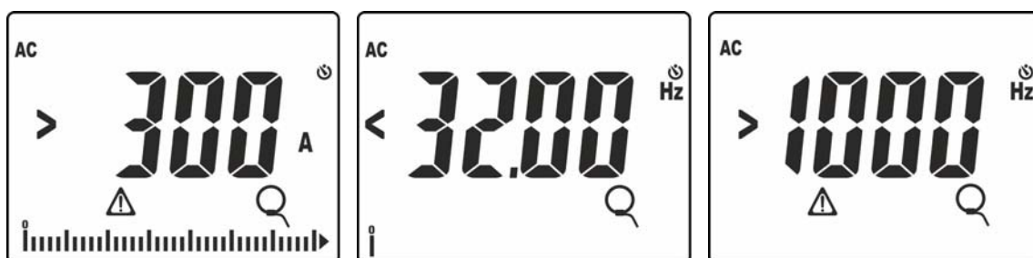
Abb. 41: Anormale Situationen bei der Strommessung mit Strommesszangen
