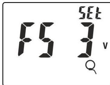
Abb. 5: Einstellung des Messbereiches der flexiblen Strommesszange
