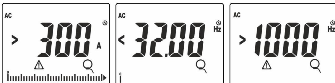
Abb. 39: Anormale Situationen bei der Strommessung mit Strommesszangen
