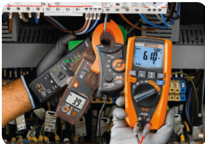
Messwertvergleich: 3.9A: mit RMS Zange - 4.7A: mit TRMS Zange 6.1A: korrekte Ablesung mit AC+DC TRMS Zange.
