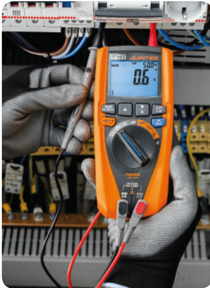
LoZ Funktion eliminiert Streuspannungen
