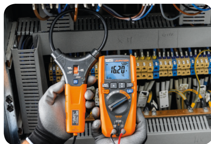
AC Strommessung mit flexiblem Wandler F3000U.
