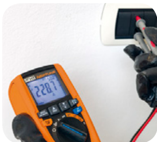
LoZ Funktion eliminiert Streuspannungen.
