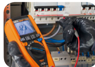
Drehfeldrichtung mit 1-phasiger Methode.
