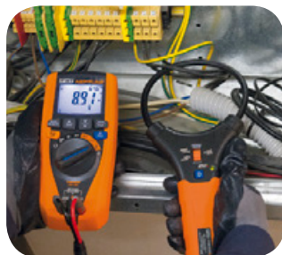
Messung des Stroms mit flexiblem Wandler.
