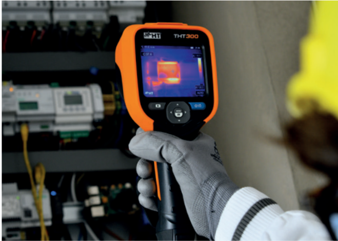
Ein überhitzer Lüftermotor aufgenommen mit der THT300
