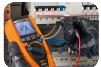
Drehfeldrichtung mit 1-phasiger Methode.
