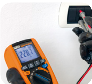
LoZ Funktion eliminiert Streuspannungen.
